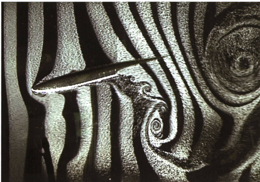
Bild 1. Semesterarbeit «Wirbelbildung an einer dynamisch belasteten Finne», Jens Stahel, 1997, Strömung von links nach rechts, Visualisierung mit der Wasserstoffblasentechnik.
