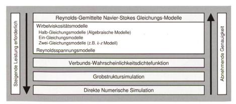
Bild 7. Fünf Methoden zur Beschreibung turbulenter Strömungen (nach Jenny und Kleiser 2007).
