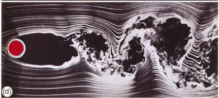
Bild 2. Verhalten einer Wasserströmung um einen Zylinder in Abhängigkeit der Reynoldszahl visualisiert mit Aluminiumpulver: (a) laminare Strömung mit Re = 1.5, (b) Strömung im Übergangsbereich mit Re = 26 und regelmässiges Wirbelpaar, (c) Strömung im Übergangsbereich mit Re = 105 und Kármánschen Wirbelstrasse und (d) turbulente Strömung mit Re = 10000 (Fotos S. Taneda in Van Dyke 1982).
