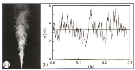
Bild 3. Turbulenter Strahl: (a) Wasserstrahl bei einer Reynoldszahl Re = 5000 (Dahm und Dimotakis 1990) und (b) zeitlicher Verlauf der Axialgeschwindigkeit in einem Luftstrahlzentrum (Pope 2006).
