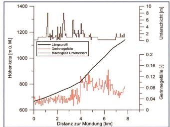
Bild 11. Längsprofil mit Darstellung des Gerinnegefälles und der Mächtigkeit der erodierbaren Unterschicht für die Chirel.
