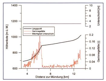
Bild 15. Längsprofil mit Darstellung des Gerinnegefälles und der Mächtigkeit der erodierbaren Unterschicht für die Schwarze Lütschine.
