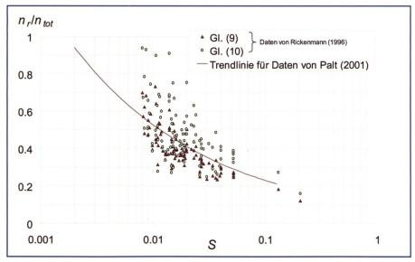
Bild 2. Verhältnis von Kornrauigkeit zu Gesamtrauigkeit (n,/n<sub>tot</sub>) in Abhängigkeit des Gerinnegefälles (S) für die Daten von Rickenmann (1996). Vergleichend gezeigt ist eine Trendlinie für unabhängige Daten von Gebirgsflüssen des Himalayas (Palt, 2001).
