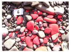
Bild 9. Geschiebetrieb bei Turbinierung bis zu 135 m<sup>3</sup>/s. Sohlenmarkierung bei US1. Markierung am 14.1.2007, Kontrolle am 21.1.2007. Entfernung vom rechten Ufer: 71 m (a, b), 52 m (c, d), 27 m (e, f), 16 m (g, h).
