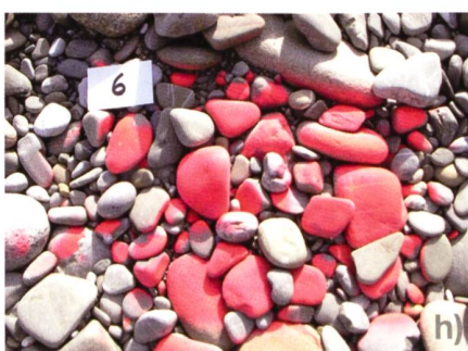
Bild 9. Geschiebetrieb bei Turbinierung bis zu 135 m 3 /s. Sohlenmarkierung bei US1. Markierung am 14.1.2007, Kontrolle am 21.1.2007. Entfernung vom rechten Ufer: 71 m (a, b), 52 m (c, d), 27 m (e, f), 16 m (g, h).
