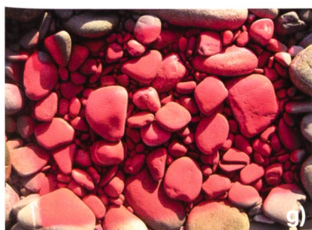
Bild 9. Geschiebetrieb bei Turbinierung bis zu 135 m 3 /s. Sohlenmarkierung bei US1. Markierung am 14.1.2007, Kontrolle am 21.1.2007. Entfernung vom rechten Ufer: 71 m (a, b), 52 m (c, d), 27 m (e, f), 16 m (g, h).
