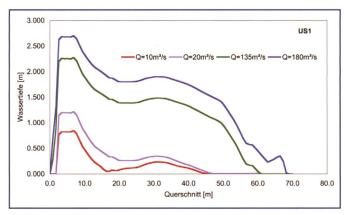
Bild 6. Wassertiefen bei US1 bei verschiedenen Abflüssen (Simulation aus 2D-Strömungsmodell). Profil siehe Bild 5.
