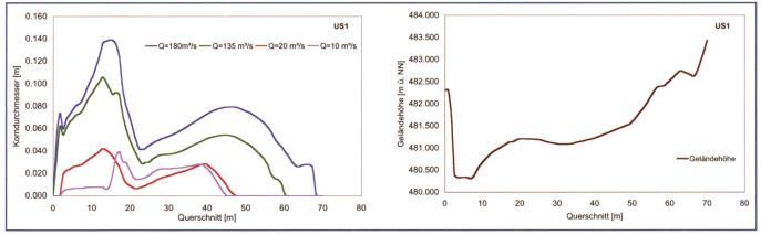
Bild 8. Bewegte Korngrössen (links) und Querprofil (rechts) bei US1 (ermittelt auf Basis der 2D-Strömungsmodellierung).
