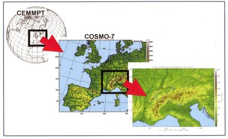
Figure 1. Imbrication des modèles utilisés à MétéoSuisse.
