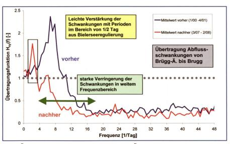
Bild 5. Übertragungsfunktionen vom Pegel Brügg-Ägerten zum Pegel Brugg vor bzw. nach Modifikation der Regelungen.
