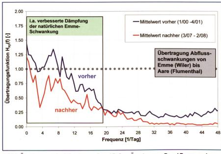
Bild 6. Übertragungsfunktionen vom Pegel Brügg-Ägerten zum Pegel Brugg vor bzw. nach Modifikation der Regelungen.
