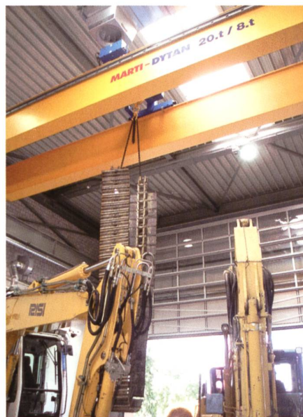
Bild 1 und 2. Mit dem 20-Tonnen-Zwei träger-Laufkran wird eine demontierte Rau-penkette eines Schaufelbaggers in die zur Reinigung und Wartung vorgesehene Zone transportiert. Bilder: Feurstein
