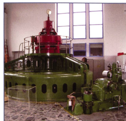
Bild 2. Maschinengruppe 3 des Kraftwerks Aue, Baujahr 1925, mit Francisturbine 1.2 MW und Generator 1800 kVA.
