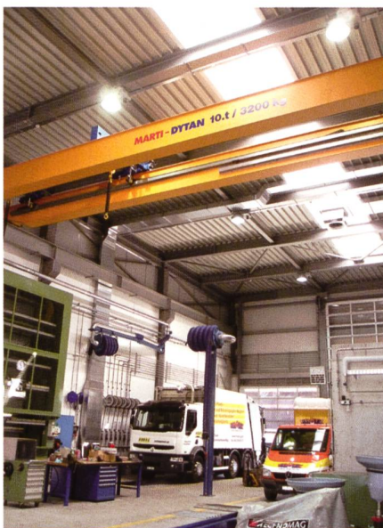
Bild 3. Im Lkw-Bereich ist ein Zweiträger-Laufkran mit einer Gesamttraglast von 10 Tonnen installiert.
