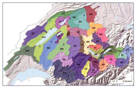
Bild 1. Einzugsgebiet Aare Murgenthal mit Gliederung der Teileinzugsgebiete (Gebietsgrössen in km²) sowie den berücksichtigten Abflussmessstationen (blaue Punkte)
