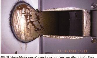
Bild 5. Verschleiss des Korrosionsschutzes am Abzugrohr System HSR.
