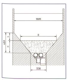
Bild 1. Entsanderabmessungen Titer und der Berechnungen zugrundegelegter Sandaustrag.
