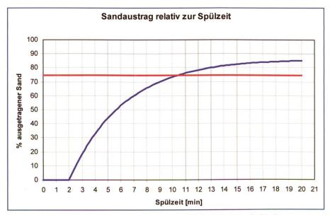
Bild 2. Kumulierte, ausgetragene Sandmenge in Abhängigkeit der Spülzeit.
