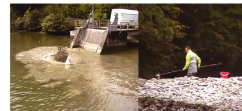
Bild 6. Das vor den Einlauf gepumpte Wasser-Sediment-Gemisch anlässlich der Testbaggerung (links) und Personal der SAK bei der Entnahme einer Wasserprobe in der Sitter, rund 300 m unterhalb des Eintritts des Unterwassers in den Fluss (rechts).
