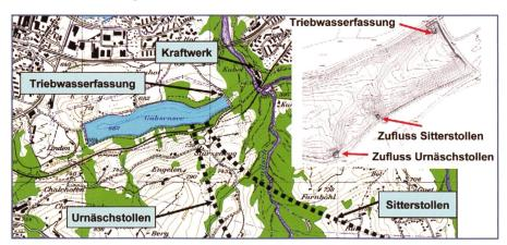
Bild 1. Situation Kraftwerk Kubel mit Zuleitungen und Gübsensee.
