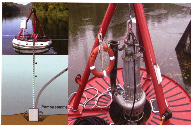
Bild 4. Aufnahme des anlässlich der Testbaggerung eingesetzten Saugbaggers SMART LIGHT auf dem Gübsensee.
