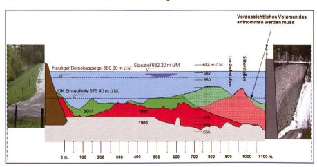
Bild 2. Schematischer Längsschnitt durch Gübsensee mit Darstellung der zeitlich versetzt eingetragenen Verlandungen.
