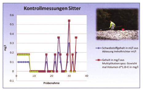
Bild 7. Gemessene Schwebstoffkonzentrationen während dem Testversuch.
