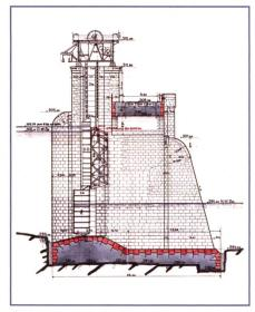
Bild 1. Eine der vier Wehröffnungen der Wehranlage Laufenburg.
