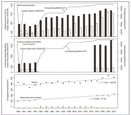
Bild 2. Entwicklung des Energieverbrauchs, der damit verbundenen Kosten und der Energiekennzahlen für Heizen und Elektrizität zwischen 1990 und 2007: (A) Jährlicher Energieverbrauch, assoziierte Kosten und Energiebezugsfläche für Heizen, (B) Jährlicher Verbrauch, assoziierte Kosten und Energiebezugsfläche für Elektrizität, und (C) Entwicklung der Energiekennzahlen für Heizen und Elektrizität über diesen Zeitraum.
