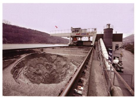
Bild 1. Der revidierte Portalkran im Werk Niederstad ist auf 6.8 Tonnen Tragkraft ausgelegt und mit einem 2.10-Kubikmeter-Schalengreifer ausgerüstet.
