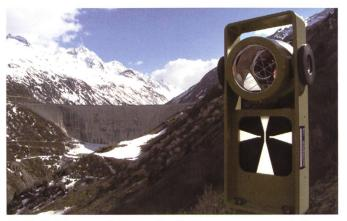
Bild 9. Präzisionsreflektoren für die Distanzmessung mit dem Mekometer ME5000.
