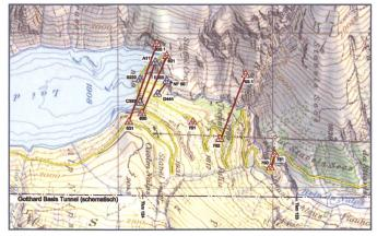
Bild 7\*. Talquerende Distanzen, Staumauer Nalps.
