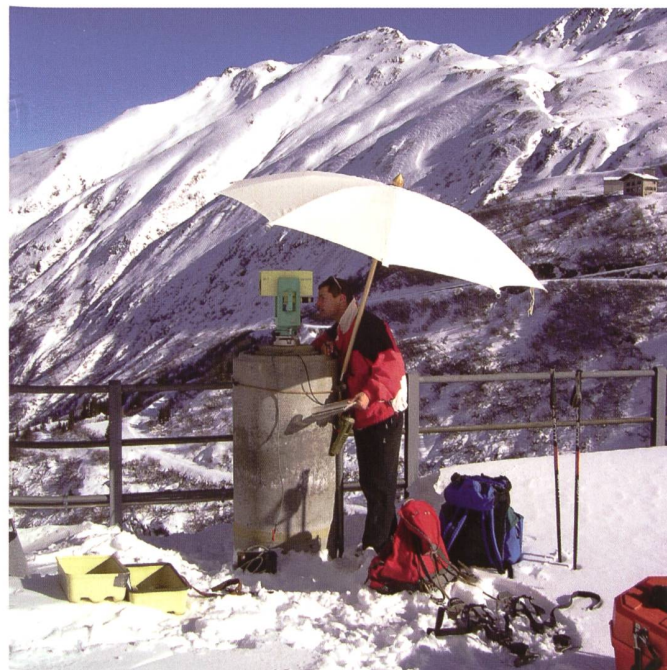
Bild 6. Distanzmessung mit dem Mekometer ME5000 auf der Staumauer Nalps.
