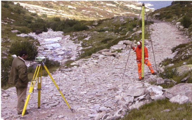
Bild 4. Nivellement im Val Termine.
