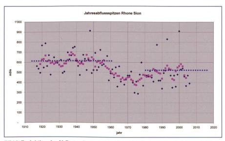
Bild 6. Reduktion der Abflussspitzen der jährlichen Hochwasser an der Rhone bei Sion nach dem Bau der grossen Kraftwerksspeicher in den 50er- und 60er-Jahren des 20. Jahrhunderts (Blau: Jahresabflussspitzen, Magenta: 5-jährliche gleitende Mittel).
