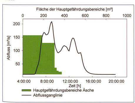
Bild 8. Hauptgefährdungsbereiche in Abhängigkeit vom Abfluss.
