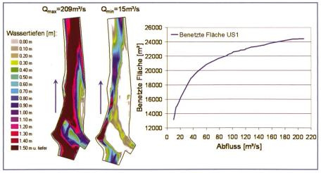
Bild 4. Wassertiefen bei Maximal- und Minimalabfluss und benetzte Fläche in Abhängigkeit vom Abfluss.
