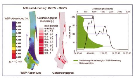
Bild 6. Gefährdungsgrad bezüglich der Sunkrate in Abhängigkeit vom Abfluss.
