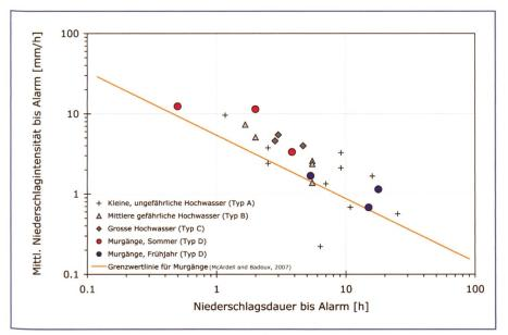
Bild 5. Grenzbeziehung zwischen Niederschlagsdauer und mittlerer Niederschlagsintensität für die Murgangbildung im Illgraben (McArdell and Badoux, 2007). Die
