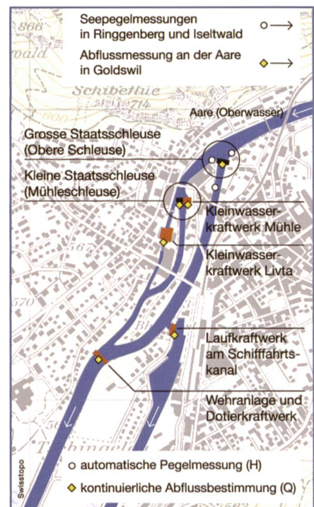
Bild 3. Lage und Art der Abflussorgane und der Messeinrichtungen (Quelle [1]).
