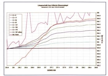
Bild 7. Kanalabfluss – Längsschnitt des Kanals (Quelle [3]).
