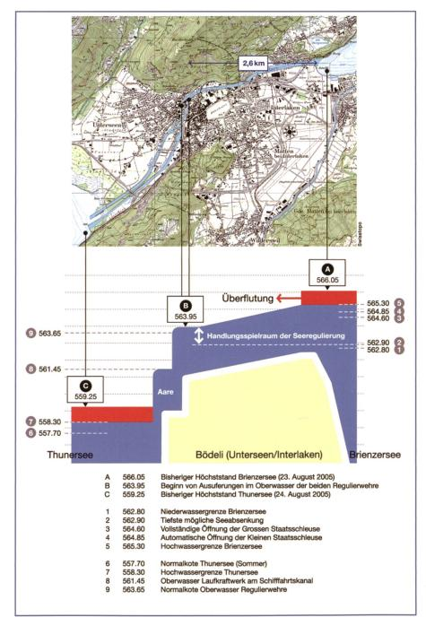
Bild 2. Die Regulierung des Brienzersees erfolgt nicht unmittelbar am Seeausgang, sondern weit davon entfernt, inmitten eines dicht bebauten Gebietes zwischen Unterseen und Interlaken (Quelle [1]).
