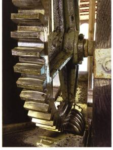
Bild 5. Torantrieb (Quelle [2]).
