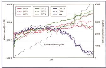
Bild 8. Wasserspiegellagen an verschiedenen Pegelstandorten im Oberwasser der Matteschwelle bei konstantem Abfluss  $Q_{max}$  HQ2005 mit 605 m³/s und stufenweiser Schwemmholzzugabe; Lage der Pegel siehe Bild 6.
