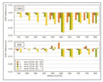
Bild 5. Wasserspiegelabsenkungen bezogen auf die Ausgangssituation mit allen Tafelschützen, exemplarisch für den vorderen Bereich (OW2) und für den Kraftwerkskanal (KW). Die Lage der Pegelmessstellen kann Bild 6 entnommen werden.
