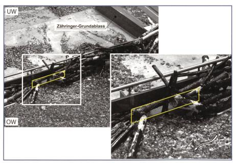
Bild 10. Verklausung der Tafelschützen mit Blick ins Unterwasser (UW) nach einem Versuch. Mit dem gelben Rahmen ist der Abflussquerschnitt (Öffnung) des Tafelschützes Nr. 28 markiert. Deutlich wird das Grössenverhältnis des Schwemmholzes zu den vorhandenen Öffnungen des Wehres.
