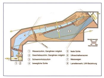
Bild 3. Hydraulisches Modell der Matteschwelle, Modellmassstab 1:50.
