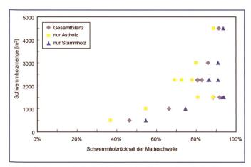
Bild 7. Schwemmholzrückhalt an der Matteschwelle in Abhängigkeit der zugegebenen Schwemmholzmenge und Schwemmholzklasse.
