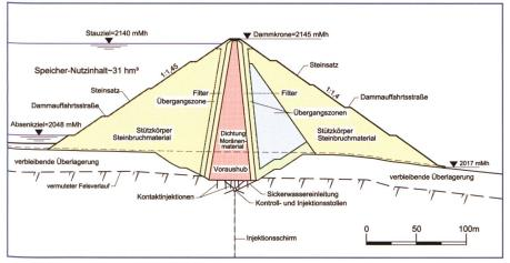
Bild 4. Steinschüttdamm Kühtai, Hauptquerschnitt.
