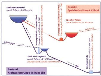
Bild 3. Hydraulisches Schema.
