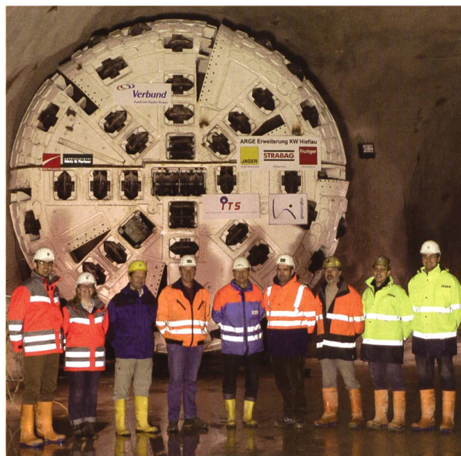
Bild 8. Fräskopf im Verzweigungsbereich des neuen Triebwasserweges.
