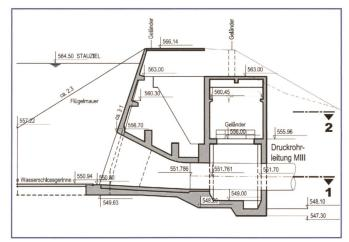
Bild 7. Anbindung der Maschine M III-Übersicht.
