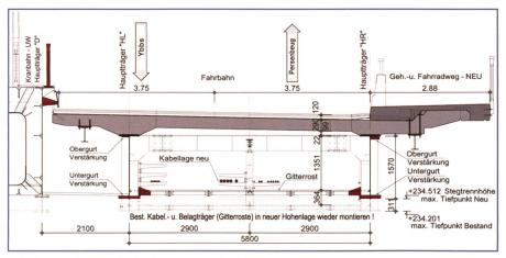
Bild 3. Regelquerschnitt der Strassenbrücke.
