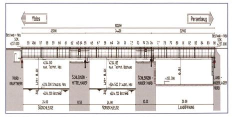
Bild 4. Längsschnitt - Kranbahnträger (zweifach überhöht).
