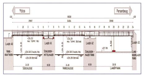
Bild 2. Längsschnitt des UW-seitigen Hauptträgers (zweifach überhöht).
