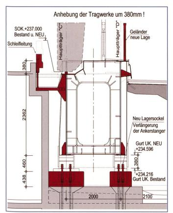
Bild 5. Regelquerschnitt – Kranbahnträger (UW-seitig) mit Schleifleitung.
