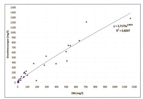
Bild 5. Zusammenhang  $SSC_{Einzelmessungen} = f(SSC_{OBS})$  in der Entnahmekammer und Korrelation als Potenzfunktion über die gesamte Schwebstoffsaison 2008.
