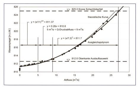
Bild 4. Wasserstand-Abfluss-Beziehung des Auslaufbauwerkes.
