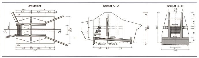
Bild 3. Das Auslaufbauwerk des Geschiebesammlers, Draufsicht und Schnitte.
