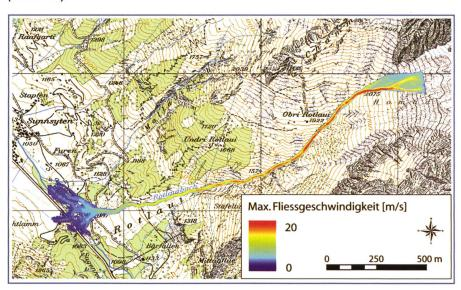
Bild 7. Mit RAMMS berechnete Fliessgeschwindigkeit des Murganges (swisstopo JA082265).
