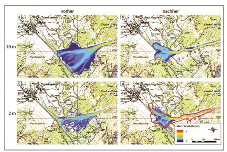
Bild 6. Resultate mit RAMMS basierend auf einem DHM10 vor bzw. nach dem Ereignis (a bzw. b) sowie auf einem DTM-AV vor und nach dem Ereignis (c bzw. d). Das Murgangvolumen beträgt jeweils 50000 m<sup>3</sup>. Reproduziert mit Bewilligung der swisstopo (JA082265).
