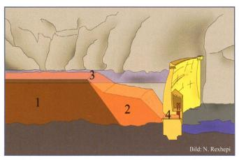
Bild 3. Aufbau Verlandungskörper; 1 Kiesiger Verlandungskörper; 2 Feinsedimente; 3 Böschungsoberkante; 4 Grundablässe.
