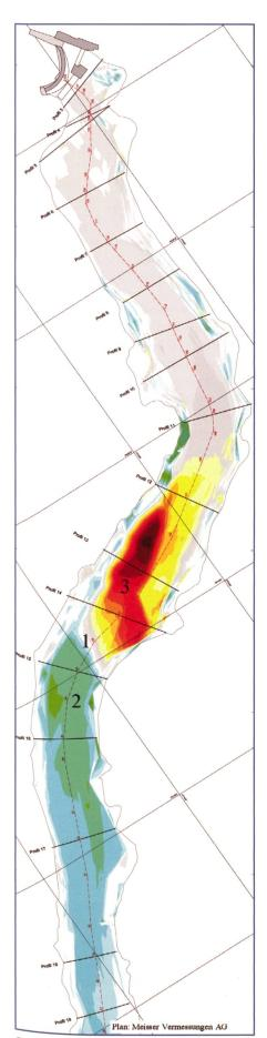
Bild 4. Differenzplot Seegrund; 1 Böschungsoberkante 2 Erosionsgerinne
