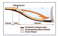
Bild 3. Schematische Darstellung des Sedimenttransports durch Trübeströme in Stausseen (Oehy und Schleiss, 2003).
