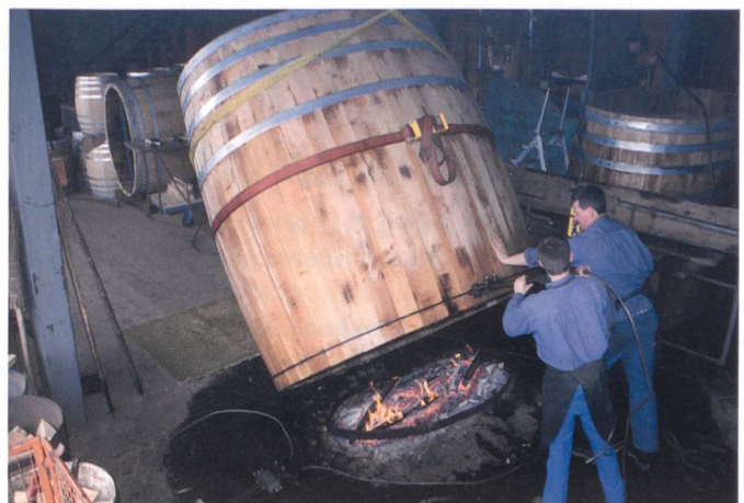
Bild 2. Biegen der Dauben mit Wasser und Feuer.
