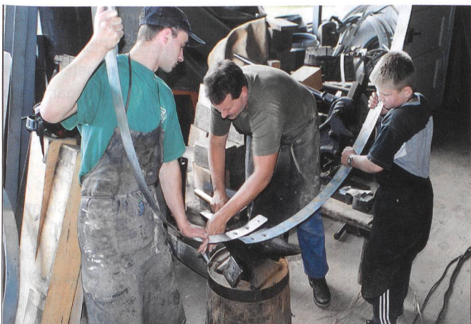
Bild 1. Vorbereiten der Fassreifen.
