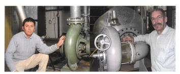
Bild 4. Jean Prénat (rechts) befasst sich seit Langem mit der Frage nach der Nutzung von Pumpen zur Turbinierung von Wasser bei kleineren Leistungen. Die Forschungsarbeiten an der EIG wurden von Jorge Arpe (links), einem EPFL-Absolventen, unterstützt, (Bilder 1-4: EIG).
