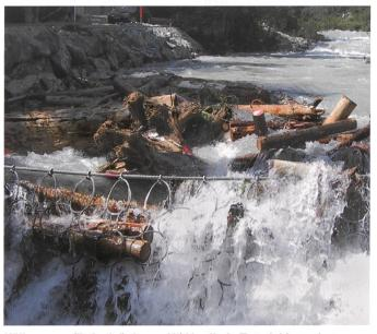
Bild 3. Labor- und Feldtest der TU München mit schematischem Auffüllprozess (Beispiel), 3a und b) Vertikale Entwicklung des Holzverhaus, 3 c) Beginn horizontale Entwicklung des Holzverhaus, 3 d) Ausgebildeter schwimmender Holzteppich.
