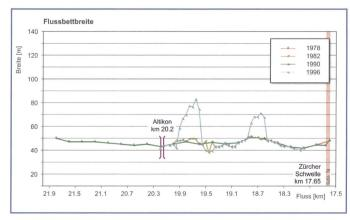
Bild 7. Flussbettbreite an der Thur bei Altikon vor Realisierung der Flussaufweitung (VAW, 2007).
