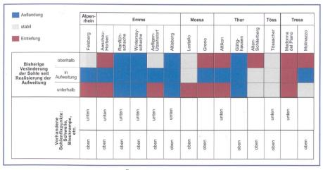
Bild 11. Analyse von Naturdaten. Übersicht über die ausgewerteten Sohlenlagen hinsichtlich der Veränderung der Sohle seit der Realisierung der Aufweitung. Es wurden die Flussstrecken oberhalb und unterhab sowie die Aufweitung selbst getrennt betrachtet. Das Vorhandensein von Sohlenfixpunkten wird ebenfalls angegeben (VAW, 2007).
