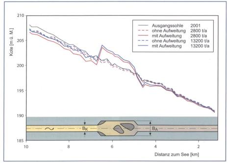
Bild 3. Ticino zwischen Bellinzona und der Mündung in den Lago Maggiore. Prognostizierte Sohlenlagen in einer Aufweitung im Vergleich zum Referenzfall ohne Massnahmen. Simulationsergebnisse für Geschiebezufuhren von 2800 und 13000 t/a (VAW, 2004).
