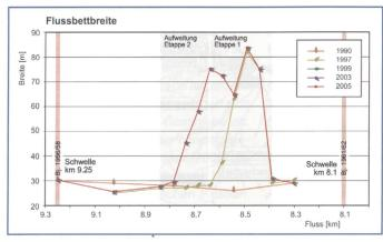
Bild 5. Mittlere Flussbettbreite an der Emme bei Aefligen-Utzenstorf nach Realisierung der Flussaufweitung (VAW, 2007).
