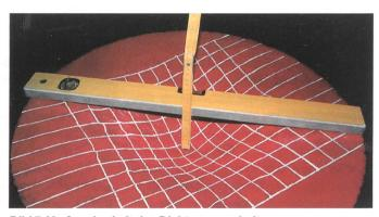
Bild 5. Verformbarkeit des Dichtungsasphaltes.
