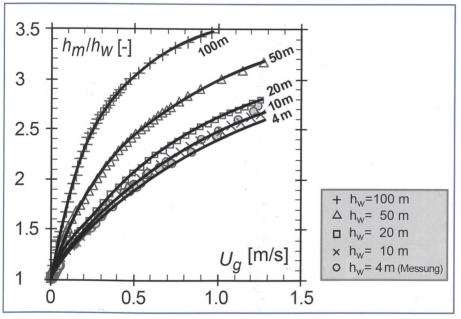
Bild 8. Berechnung des relativen mittleren Wasserspiegelanstiegs  $h_m/h_w$  in Abhängigkeit der bezogenen Luftgeschwindigkeit  $U_g$  und des Ausgangswasserspiegels  $h_w$  unter Berücksichtigung des Einflusses der Dichte auf die Verteilung der Blasengrössen nach Letzel (1999) und unter Berücksichtigung des sich ändernden Luftvolumenstroms über die Steigrohrhöhe.
