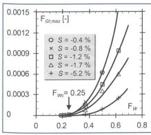
Bild 3. Dimensionslose bezogene Luftgeschwindigkeit F<sub>Gt,max</sub> der maximal transportierten Luft in Abhängigkeit der dimensionslosen bezogenen Wassergeschwindigkeit F<sub>W</sub> und der Stollenneigung S. Die Kurven zeigen die Interpolation zwischen den Messpunkten und die Extrapolation für grössere Wassergeschwindigkeiten.
