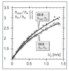
Bild 7. Relativer mittlerer  $h_m/h_w$  und relativer maximaler  $h_{max}/h_w$  Wasserspiegelanstieg in Abhängigkeit der bezogenen Luftgeschwindigkeit  $U_g$  in vertikalen Entlüftungsrohren mit einem Durchmesser von 0.09 m < d < 0.48 m. Zusätzlich sind die Berechnungen nach Gleichung 8 und 9 eingetragen.
