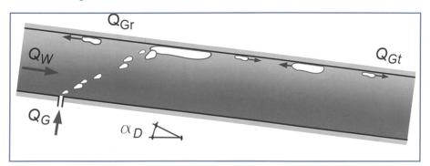
Bild 2. Schematische Darstellung der Bewegungsrichtung von Luft in abwärts geneigten Druckstollen bei konstantem Lufteintrag. In Abhängigkeit der Stollenneigung ( $\alpha_D$ ) und des Volumenstroms des Wassers ( $Q_W$ ) und der Luft ( $Q_G$ ) bewegt sich ein Teil der Luft stollenaufwärts ( $Q_{G}$ ), und ein Teil wird mit der Wasserströmung transportiert ( $Q_{G}$ ).
