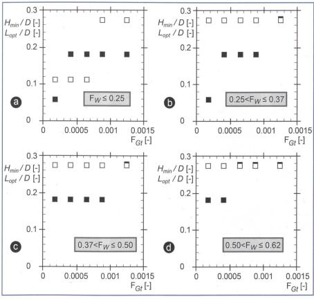
Bild 5. Relative Mindestkammerhöhe  $H_{min}$  ( $\blacksquare$ ) und die optimale Kammerlänge  $L_{opt}$  ( $\square$ ) in Abhängigkeit der dimensionslosen bezogenen Luftgeschwindigkeit  $F_{Gt}$  der transportierten Luft und der dimensionslosen bezogenen Wassergeschwindigkeit  $F_{W}$  für eine Austragrate von  $\eta \ge 99.9\%$  bei einer minimalen Kammerbreite von  $B > 0.5 \cdot D$ .
