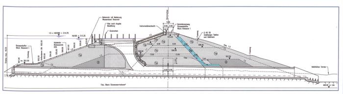
Bild 6. Dammquerschnitte A-A (oben) und B-B (unten) mit Kernbereich, Stützkörperzonen aus verschiedenen Schüttmaterialien sowie Filter- und Drainagezonen.
