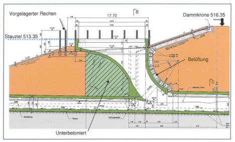
Bild 3. Längsschnitt durch die Hochwasserentlastung.
