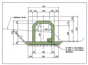
Bild 2. Querschnitt des Durchlasses unterhalb der Hochwasserentlastung.
