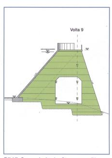
Bild 7. Querschnitt der Staumauer Pian Sapeio.
