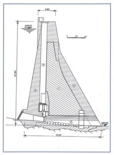
Bild 6. Querschnitt der sanierten Staumauer Muslen.
