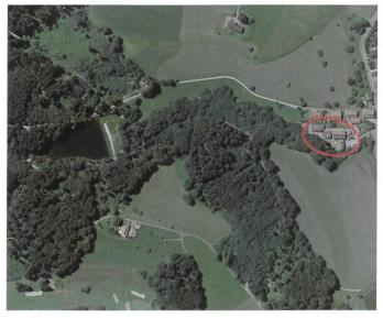
Bild 1. Luftbild des unteren Luppmenweihers in Hittnau bei Pfäffikon ZH. Ehemalige Wasserkraftanlage von 1876, heute Naturschutzgebiet, Weiher mit 6 m Stauhöhe und 32 000 m³ Stauvolumen. Die ehemaligen Fabrikgebäude werden heute bewohnt und liegen im Flutwellenabflussgebiet bei einem allfälligen Dammbruch. Diese Stauanlage ist aufgrund des Kriteriums der besonderen Gefahr der StAV zu unterstellen.
