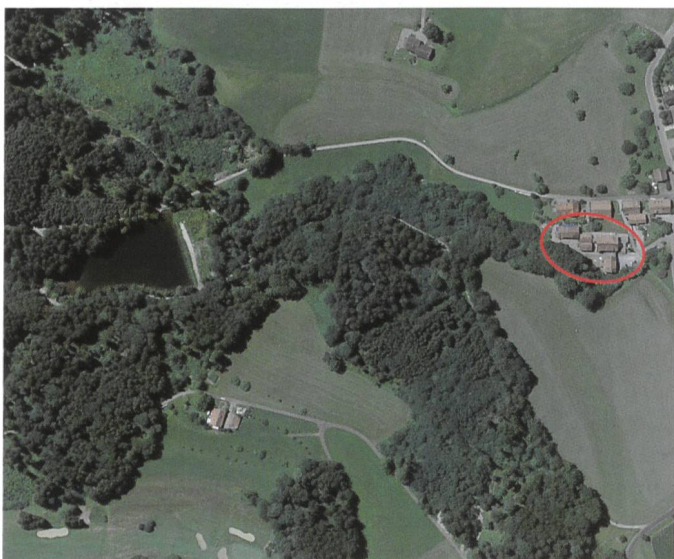
Bild 1. Luftbild des unteren Luppenweihers in Hittnau bei Pfärfikon ZH. Ehemalige Wasserkraftanlage von 1876, heute Naturschutzgebiet, Weiher mit 6 m Stauhöhe und 32000 m³ Stauvolumen. Die ehemaligen Fabrikgebäude werden heute bewohnt und liegen im Flutwellenabflussgebiet bei einem allfälligen Dambruch. Diese Stauanlage ist aufgrund des Kriteriums der besonderen Gefahr der StAV zu unterstellen.
