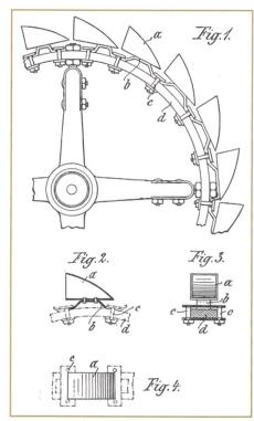
Bild 6. Wasserrad mit auswechselbaren Schaufeln.
