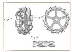
Bild 4. Wasserrad mit trichterförmigen Schaufeln.
