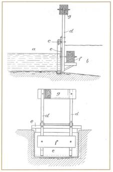
Bild 5. Seitenansicht (oben) und Ansicht von unten (unten) der Wasserfalle zum selbsttätigen Regulieren des Oberwasserstandes in Kanälen.
