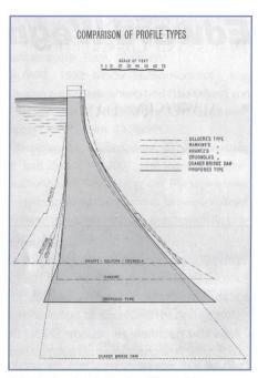
Bild 3. Vergleich der Profile für New Croton Dam.
