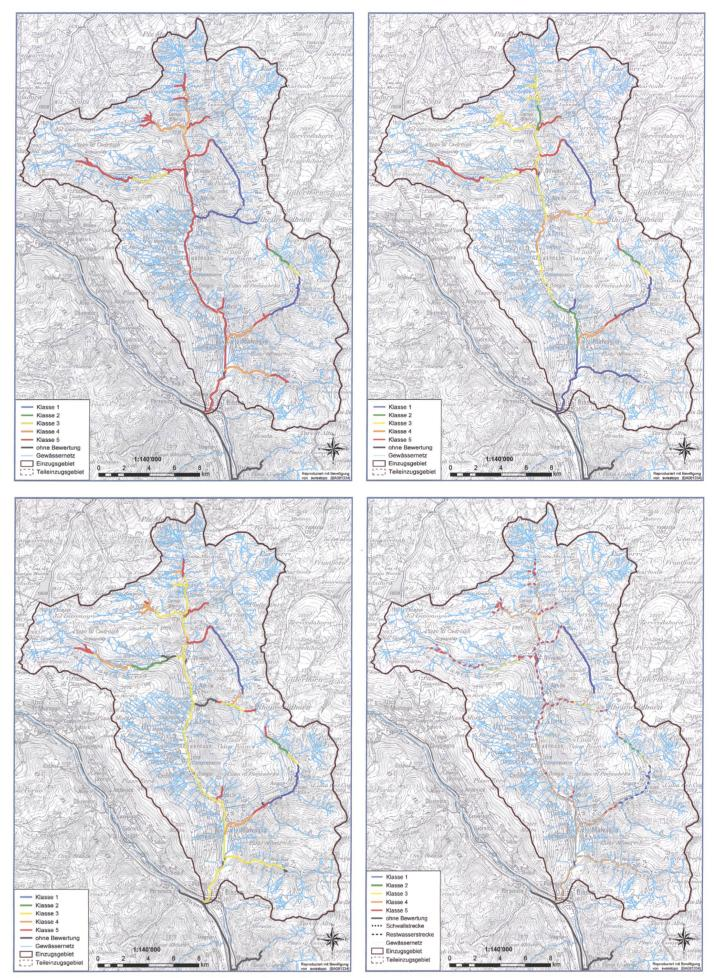
Bild 9. Fallbeispiel Brenno im Bleniotal, Kanton Tessin. Ergebnisse für einzelne Bewertungsindikatoren von HYDMOD-F. Links oben: Niederwasserabfluss. Rechts oben: Niederwasser-Saisonalität. Links unten: Hochwasser-Häufigkeit. Rechts unten: Gesamtbewertung.
