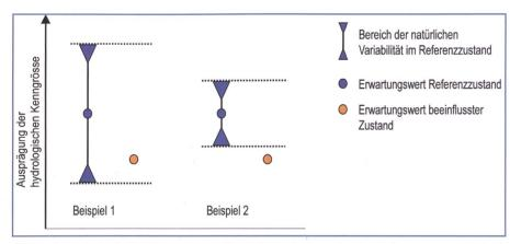
Bild 3. Grundprinzip der Bewertung: Gegenüberstellung des beeinflussten zum Referenzzustand unter Berücksichtigung der natürlichen Variabilität.
