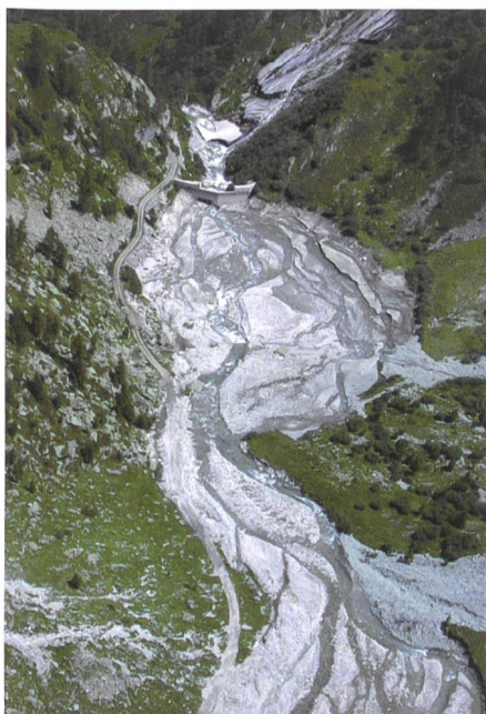
Bild 6. Massive Geschiebeablagerungen beim Rückhaltebecken des Stauwehrs Föh am Grossen Wasser (Zwischbergen-tal, Kt. Wallis) als Folge des Hochwassers vom 15. Oktober 2000 (Foto aus Dussex, 2002).
