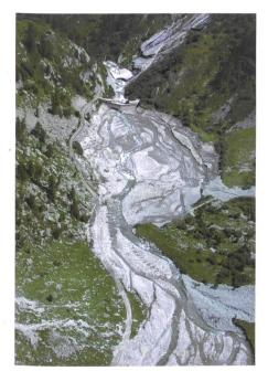
Bild 6. Massive Geschiebeablagerungen beim Rückhaltebecken des Stauwehrs Fäh am Grossen Wasser (Zwischbergental, Kt. Wallis) als Folge des Hochwassers vom 15. Oktober 2000 (Foto aus Dussex, 2002).
