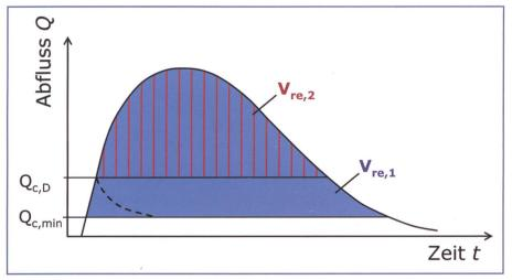
Bild 1. Zusammenhang zwischen Abflussganglinie und Transportberechnung. Illustriert sind zwei Hauptfälle: (i) Berechnung mit einem unteren Grenzabfluss  $Q_{c,min}$  und der entsprechenden effektiven Wasserfracht  $V_{re,1}$ , sowie (ii) Berechnung mit dem kritischen Abfluss  $Q_{c,D}$  und der entsprechenden effektiven Wasserfracht  $V_{re,2}$ .
