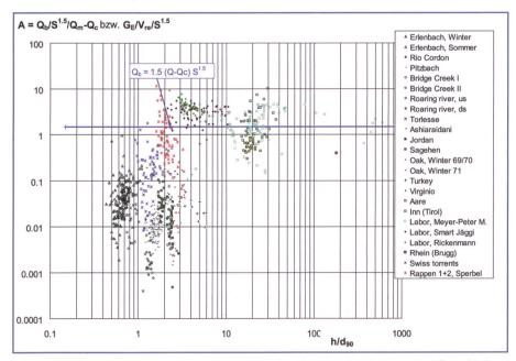
Bild 2. Der Koeffizient A (Gl. 7 und 8) ist aus weltweiten Beobachtungen zu Geschiebetransport und Abfluss berechnet und in Abhängigkeit der relativen Abflusstiefe  $h/d_{90}$  aufgetragen (modifiziert nach Rickenmann, 2001). Insbesondere bei kleinen Werten von  $h/d_{90}$  liegt A zum Teil deutlich unter 1.5 (Wert gemäss Gl. [3], welche hier durch die blaue Linie dargestellt ist).
