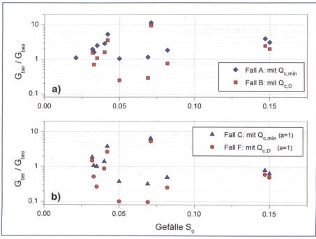
Bild 7. Verhältnis G<sub>ber</sub>/G<sub>beo</sub> in Abhängigkeit des Gerinnegefälles für die Fälle A und B (obere Grafik) und für die Fälle C und F (untere Grafik); die Daten sind in Tabelle 5 angegeben.
