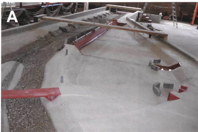
Bild 4. Physikalisches Modell der Versuchsanstalt für Wasserbau und Wasserwirtschaft der TU München (Obernach). A: Modellierte Aare, Gadmerwasser und Beruhigungsbecken ohne Abfluss; B: Modellierte Aare, Gadmerwasser und Beruhigungsbecken bei Hochwasserabfluss.
