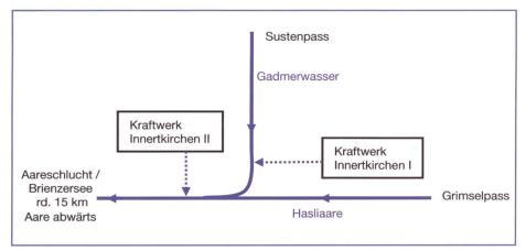
Bild 1b. Lageplan der Kraftwerke Innertkirchen I und II sowie deren Wasserrückgaben (blaue gestrichelte Pfeile) in das Gadmerwasser (Fliessrichtung von oben nach unten) und in die Hasliaare (Fliessrichtung von rechts nach links).
