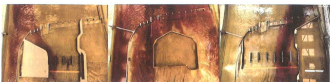
Bild 8. Hydraulisches Modell Baugruben.
