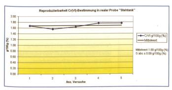
Bild 9. Reproduzierbarkeit Cr(VI)-Bestimmung an realer Probe «Stehtank».
