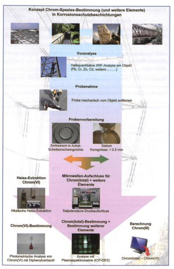
Bild 11. Analysenkonzept für die Chrom-Spezies-Analytik.
