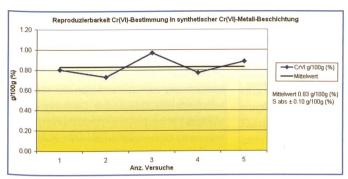
Bild 8. Reproduzierbarkeit synthetische Cr(VI)-Beschichtung auf Stahloberfläche.
