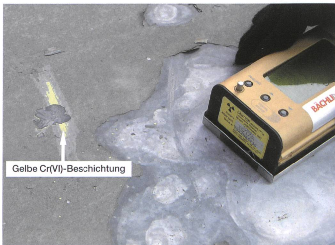
Bild 5. Voruntersuchung vor Ort mit mobilem Röntgenfluoreszenzspektrometer.
