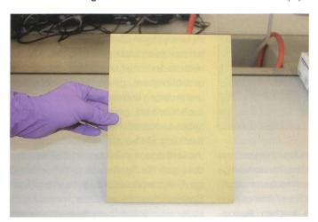
Bild 4. Zinkchromat-Referenzbeschichtung auf Stahlplatte mit 0,9% Chrom(VI).
