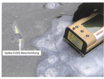
Bild 5. Voruntersuchung vor Ort mit mobilem Röntgenfluoreszenzspektrometer.
