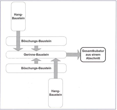
Bild 2. Schematische Darstellung der Feststofflieferung aus den Hang-, Böschungsund Gerinnebausteinen eines Bachabschnittes.
