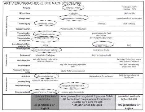
Bild 5. Anwendungsbeispiel Checkliste Nachböschung mit dem Beispiel einer möglichen Beurteilung (markiert).
