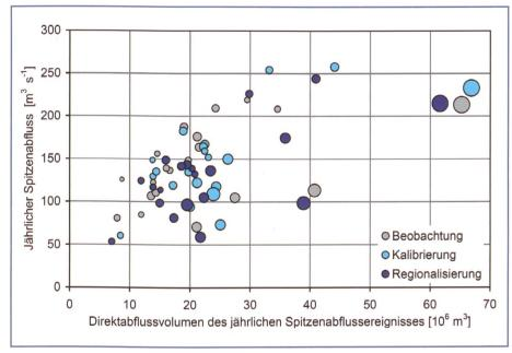
Bild 7. Jährliche Spitzenabflüsse und zugehörige Direktabflussvolumina für die Kleine Emme bei Littau auf Basis täglich aufgelöster Daten. Die Grösse der Signatur ist proportional zur Ereignisdauer.
