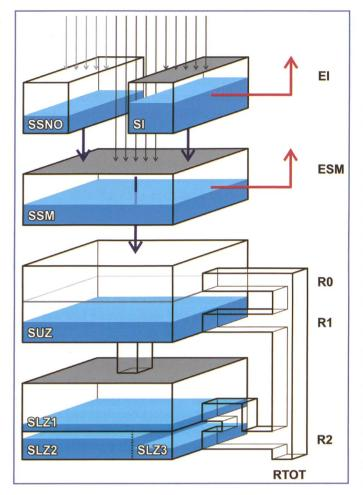
Bild 2. Struktur des hydrologischen Modellsystems PREVAH mit Speichermodulen (SSNO: Schneespeicher, SI: Interzeptionsspeicher, SSM: Bodenfeuchtespeicher, SUZ: Oberer Abflussspeicher, SLZ1-SLZ3: Basisabflussspeicher) und hydrologischen Flüssen (EI: Interzeptionsverdunstung, ESM: Bodenverdunstung, R0: Oberflächenabfluss, R1: Zwischenabfluss, R2: Basisabfluss, RTOT: Gesamtabfluss).
