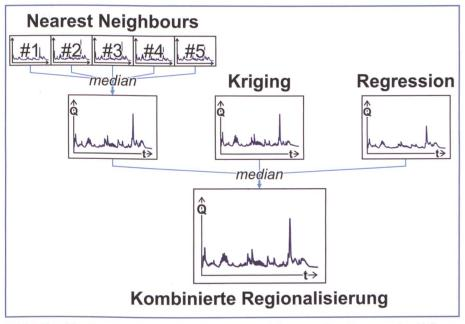
Bild 4. Kombination von drei Regionalisierungsverfahren zur Bestimmung der Abflussganglinie eines ungemessenen Einzugsgebietes.
