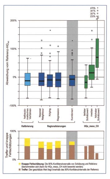
Bild 5. Schätzgüte für ein HQ<sub>100</sub> bei Kalibrierung und Regionalisierung des Modells, bewertet auf Basis von 49 repräsentativen Einzugsgebieten. Oben: Abweichung von der Referenz, unten: Anteil Treffer und knappe Fehlschätzungen. Die für ungemessene Gebiete verwendete kombinierte Regionalisierung ist grau hinterlegt; zum Vergleich sind die entsprechenden Resultate von HQx\_meso\_CH angegeben.
