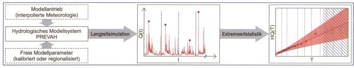
Bild 1. Prinzip der Hochwasserabschätzung mittels Langzeitsimulation.
