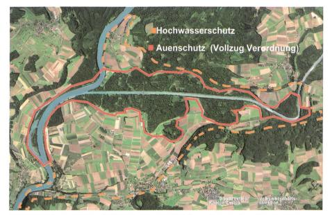
Bild 2. Die Thurmündung. Der Rhein fliesst im Bild von oben nach unten, die Thur von rechts nach links. Unten in der Mitte des Bildes erkennt man das Dorf Flaach. Orange: Projektperimeter Hochwasserschutz. Rot: Auenschutzgebiet von nationaler Bedeutung. Das vorgestellte Projekt erstreckt sich nur auf den Zürcher Teil dieses Gebietes.
