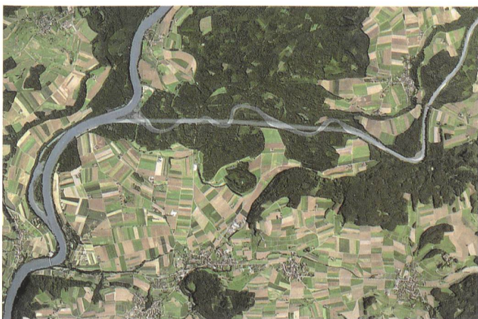
Bild 6a. Es wird erwartet, dass die Thur nach den Renaturierungsmassnahmen ihr Bett verbreitert und dass eine Mäanderbildung einsetzt. Im Bild ist ein Zustand angedeutet, wie er etwa nach 20 Jahren vorzufinden sein könnte.
