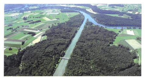
Bild 1a. Die Thur fliesst auf ihrem letzten Abschnitt vor der Mündung in den Rhein in einem begradigten, ökologisch wenig wertvollen und erst noch nicht hochwassersicheren Bett. Sie wird renaturiert und gleichzeitig hochwassersicher gemacht. Die Thur fliesst hier durch das grösste nationale Auenschutzgebiet des Mittellandes, das ebenfalls aufgewertet wird. Im Hintergrund links erkennt man das landwirtschatlich intensiv genutzte Flaacherfeld.
