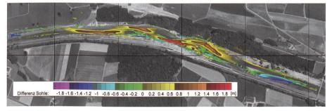
Bild 10. Gerechnete Sohlendifferenzen zwischen September 2005 und November 2004 unter Berücksichtigung der Deckschicht und einem für das laufende Geschiebe repräsentativen Korndurchmesser von  $d_m = 2,5$  cm.
