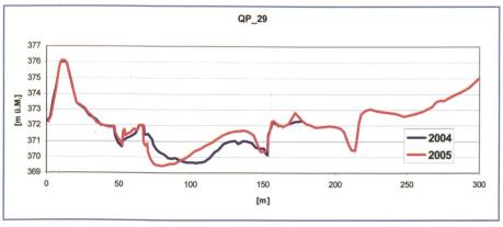
Bild 5. Veränderung der Sohle im Querprofil QP\_29 zwischen Nov. 2004 und Sep. 2005.
