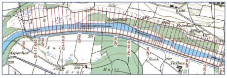
Bild 2. Topographisches Monitoring der Aufweitung bei Altikon. Die Entwicklung des Gerinnes wird mit Querprofilen mit grosser räumlicher (max. Abstand 50 m) und zeitlicher Auflösung aufgenommen.
