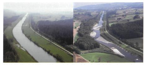
Bild 1. Die Thur bei Altikon: Links nach der Korrektion des 19. Jahrhunderts, rechts nach der Aufweitung des Hauptgerinnes. Schon zwei Jahre nach der Revitalisierungsmassnahme hat sich die morphologische Vielfältigkeit deutlich verbessert.
