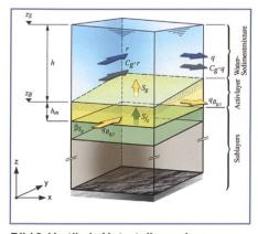
Bild 8. Vertikale Unterteilung einer Rechenzelle.
