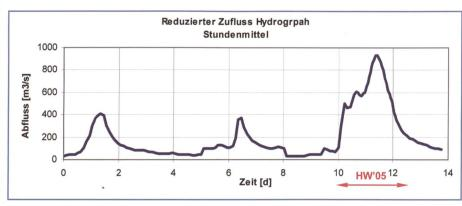
Bild 6. Reduzierter Zuflusshydrograph, der für Simulation massgeblich war.
