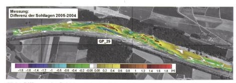
Bild 4. Differenz der Sohlelagen im Bereich des Hauptgerinnes zwischen September 2005 und November 2004.
