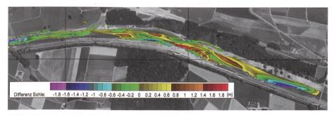
Bild 9. Gerechnete Sohlendifferenzen zwischen September 2005 und November 2004 unter Annahme eines 1-Korn-Modells und eines massgebenden Korndurchmessers von  $d_m = 5$  cm, der repräsentativ für das Sohlmaterial ist.
