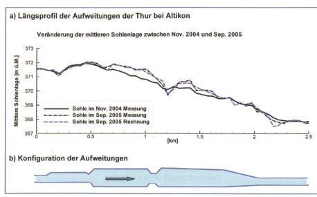
Bild 3. Veränderung der mittleren Sohle zwischen November 2004 und September 2005, a) Längsprofil der gemessenen und gerechneten mittleren Sohle, b) Schema der Konfiguration der Aufweitungen.
