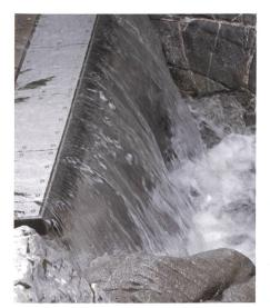
Bild 3b. Geophonsystem im Einsatz im Vogelbach (Alptal, Kt. Schwyz; Foto B. Reye, Tages-Anzeiger); die Stahlkonstruktion ist an der Unterwasserseite einer Wildbachsperre montiert. Die Stahlplatten haben Abmessungen von 36×50 cm.
