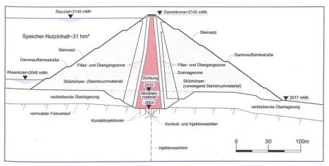
Bild 4. Steinschüttdamm Kühtai, Hauptquerschnitt.
