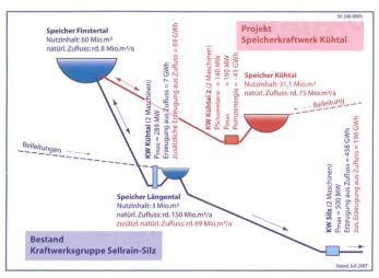
Bild 3. Hydraulisches Schema.
