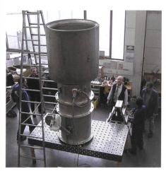
Bild 5. Vibrationsmessungen an der 18,5-kW-Turbine.
