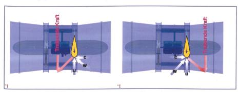
Bild 3. Wirkprinzip der Wells-Turbine: Unabhängig davon, ob die Maschine ein- oder ausatmet, rotiert die Turbine in dieselbe Richtung.
