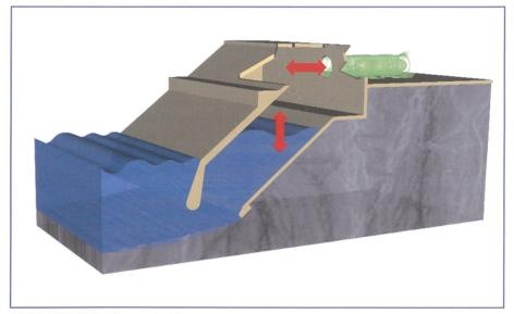
Bild 2. LIMPET im Querschnitt.
