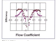
Bild 4. Wirkungsgradmessungen.
