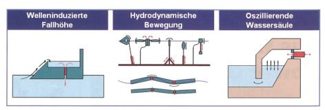
Bild 1. Drei generische Technologiecluster von Wellenkraftmaschinen.
