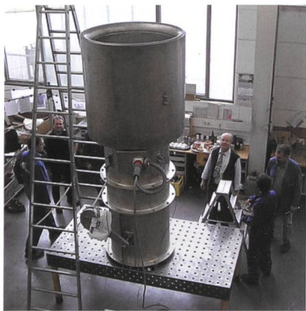
Bild 5. Vibrationsmessungen an der 18,5-kW-Turbine.
